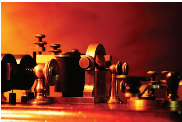
図 1.5：モールス信号送信機。電報は長距離間でコミュニケーションをとるための初の技術システムであり、使用に際して複雑な仕組みと訓練を要するものであった。
